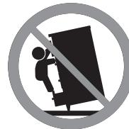
**Da se spreči prevrtanje, nameštaj mora biti trajno pričvršćen za zid pomoću elementa ili elemenata koji se dobiju ili dobijaju uz proizvod.**
