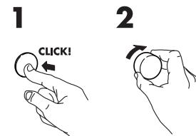
Der Bedienknopf kommt jetzt heraus. Drehen Sie ihn auf die gewünschte Stellung. Drehen Sie nach dem Ende des Garvorgangs den Bedienknopf **①** auf und drücken Sie erneut darauf, um ihn wieder in seine ursprüngliche Stellung zu bringen.
