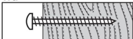
Om väggen är gjord av massivt trä kan du använda vilken som helst av skruvarna FIXA. I de flesta fall behövs ingen plugg och du behöver inte förborra.
