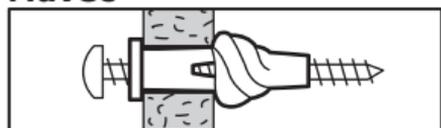
Če je vaša stena iz mavca, uporabite zidni vložek FIXA in ustrezeni vijak. Pri mavčni steni se zidni vložek FIXA razširi in tvori sidro.
