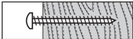
Pokud je stěna z masivního dřeva, můžete použít jakékoli vruty FIXA. Ve většině případů není nutné nejprve vyvrtat otvor.
