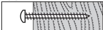
Si le support est en bois massif, vous pouvez utiliser n'importe quelle vis FIXA. Dans la plupart des cas, il n'est pas nécessaire de pré-percer ou d'utiliser une cheville. En règle générale il faut que la longueur de la vis soit deux fois supérieure à l'épaisseur de l'élément que vous voulez fixer au support en bois.
