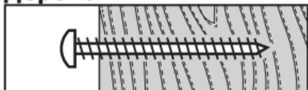
Для стен из массива дерева можно использовать любые шурупы ФИКСА. Предварительно просверливать отверстия или использовать дюбели в большинстве случаев не требуется.
