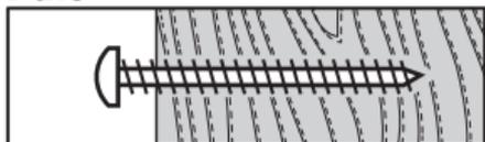
Täispuidust seinalle võite kasutada mistahes FIXA kruvisid, enamikel juhtudel ei ole vaja lisada pistikut ja puurida eelnevaid auke.
