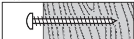
Hvis væggen er af massivt træ, kan alle FIXA skruer bruges. I de fleste tilfælde er det ikke nødvendigt med en rawlplug, og du behøver ikke at forbore.
