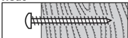
Is de muur van massief hout, dan kan je een van de FIXA schroeven gebruiken. In de meeste gevallen hoef je niet voor te boren of een plug te gebruiken.
