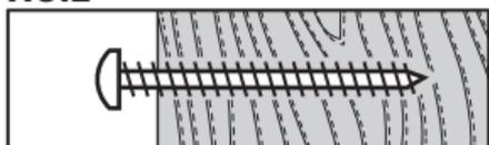
Für massive Holzwände können alle FIXA Schrauben benutzt werden. Meist ist kein Vorbohren und kein Dübel erforderlich.
