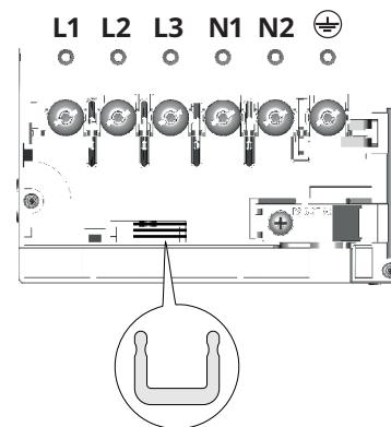
Coloque os shunts entre os terminais conforme figura
