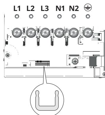
Introduceți derivatoare de curent între borne, conform ilustrației
