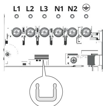
Zainstalować odgałęzienia pomiędzy zaciskami, zgodnie z ilustracją
