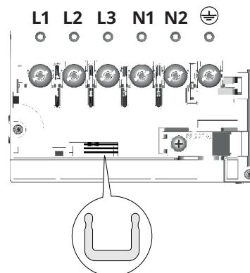
Sett strømshuntene inn mellom klemmene, som vist
