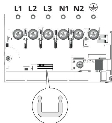
Akim şantlarını terminaller arasında gösterildiği gibi yerleştirin
