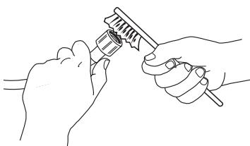
3. Далее, вручную открутите заливной шланг от патрубка на задней стороне стиральной машины. Используя плоскогубцы, вытяните сетчатый фильтр из патрубка и тщательно очистите его.
