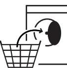
Otvorte dvierka a vložte bielizeň. Vkladajte kusy bielizne po jednom a voľne do bubna, bez preplňovania. Dodržujte maximálne množstvá plnenia uvedené v „TABUĽKE PROGRAMOV“. Preplnenie práčky má za následok nedostatočne vypratú a pokrčenú bielizeň.
