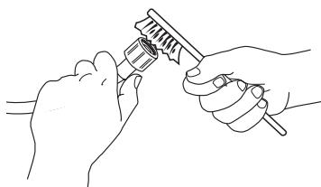
3. Şimdi çamaşır makinesinin arkasında yer alan giriş hortumunu elinizle sökün. Örgülü filtreyi çamaşır makinesinin arkasındaki valften pense ile çekip çıkarın ve dikkatli bir şekilde temizleyin.
