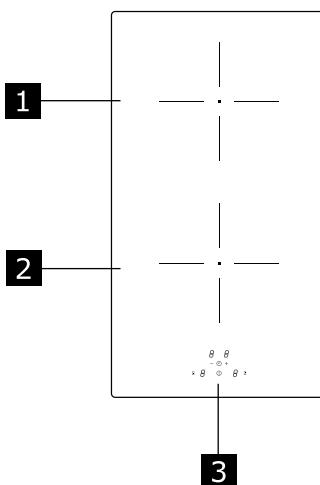
**1** Zone de cuisson simple (160 mm) 1400 W, avec fonction Boost de 2100 W.
